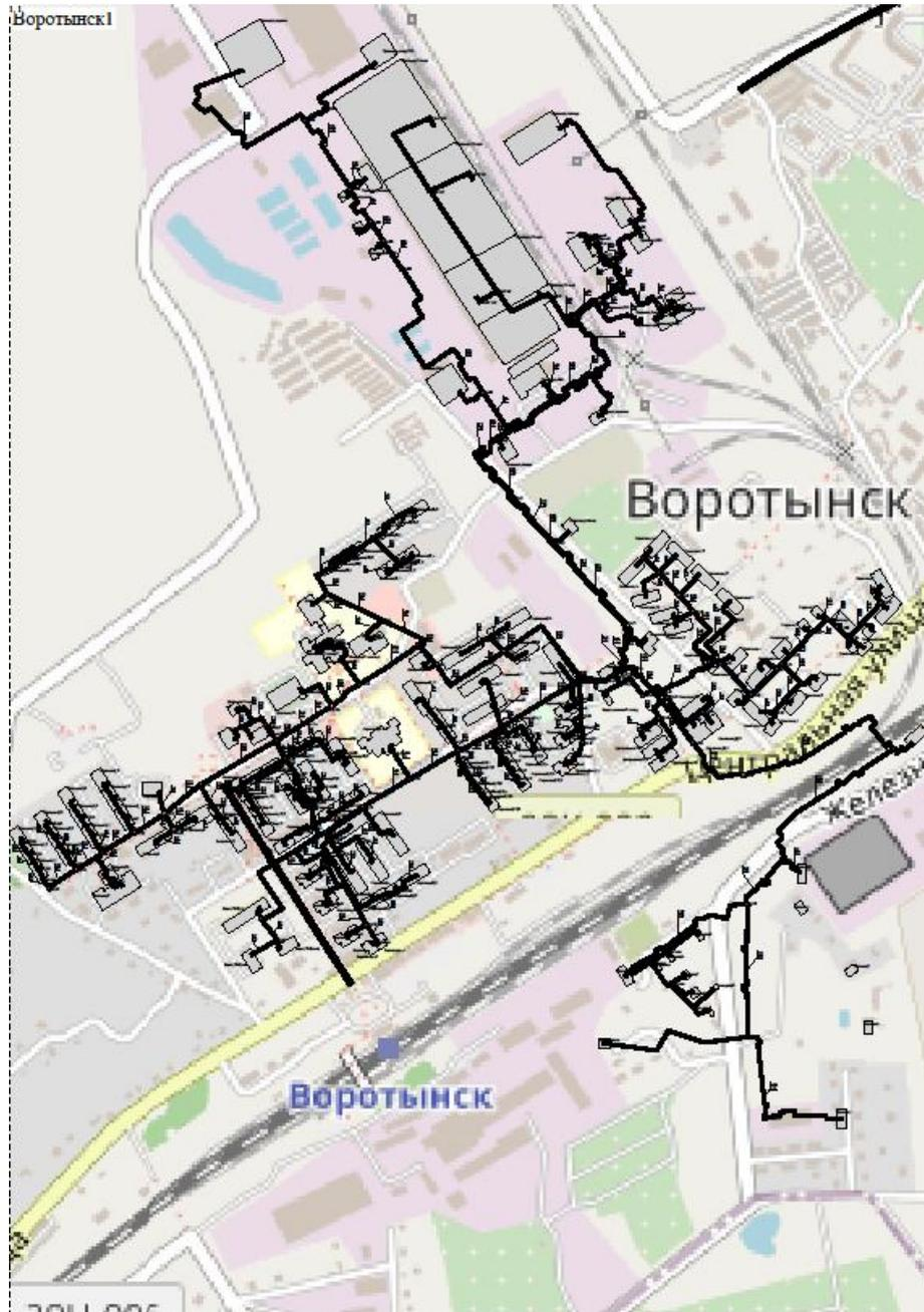
**Рисунок 3** - Расчетная схема для электронной модели системы теплоснабжения (теплоноситель на отопление) котельной №1 ООО «Тепловодоканал» поселка Воротынский
